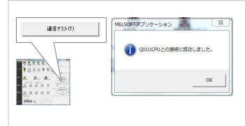
「通信テスト」ボタンをクリックします。 図のようなメッセージが表示されたら 正常です。
