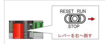
PLC のスイッチを「RUN」側に倒します。 前面の「RUN」LED が点灯し、 PLC が運転モードに移行します。
