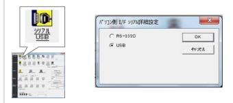
「シリアル USB」ボタンを ダブルクリック、「USB」を選択し、 「OK」ボタンをクリックします。
