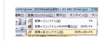
メニューバーの「変換/コンパイル」 >「変換 + 全コンパイル」を クリックします。
