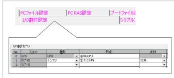
「1/0割付設定」タブを選択し、 1/0割付欄で図のように シリアルコミュニケーションユニット を割り付けます。
