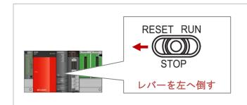
PLC のスイッチを「RESET」側に 倒したまま、前面の「ERR.」LED が 点滅した後、消灯するのを確認します。 消灯したら「STOP」位置に戻します。
